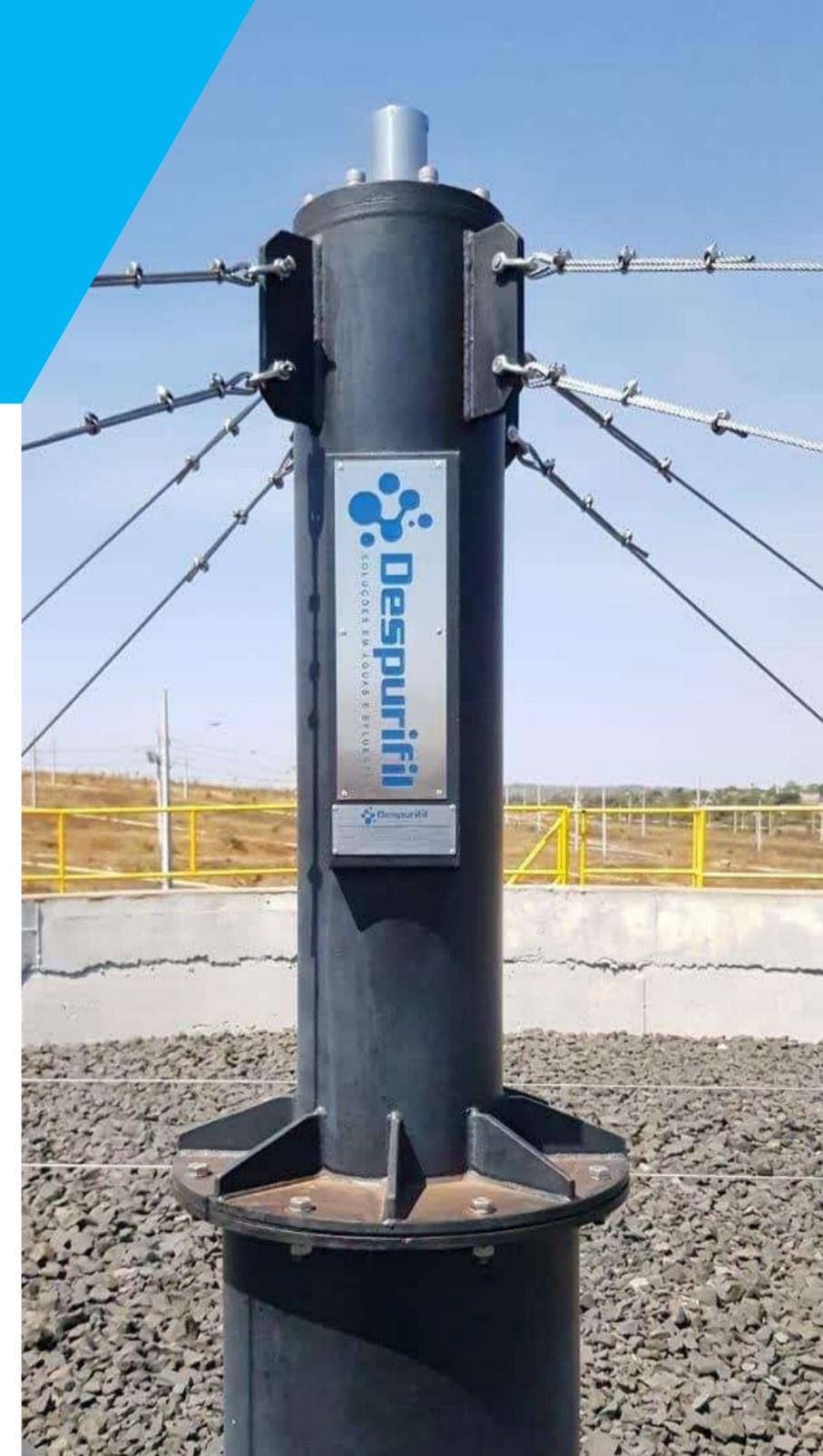
Imagem de um distribuidor rotativo Hidráulico.
